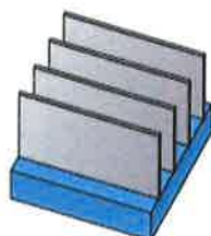
樹脂材への アルミパーツ接合
